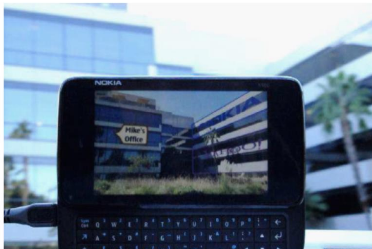
شکل ۸. محتوای اطلاعاتی ساده ارائه شده به کاربران. هر یک از دفترها و مجموعه دفاتر در خارج از ساختمان با برچسب مشخص شدند. این شرایط مربوط به AR غیر مستقیم است. AR سنتی ظاهری مشابه دارد ولی اغلب خطای ردیابی آن بیشتر است.
