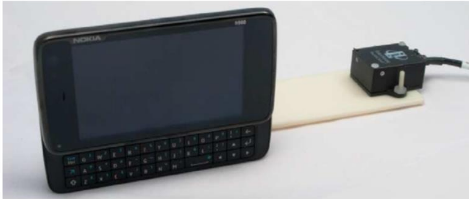
شکل ۶. گوشی نوکیا N900 مورد استفاده در مطالعه ما با به همراه InterSense و InertiaCube3 متصل به آن. برای جلوگیری از اختلالات مغناطیسی با فاصله به دستگاه متصل شد.
