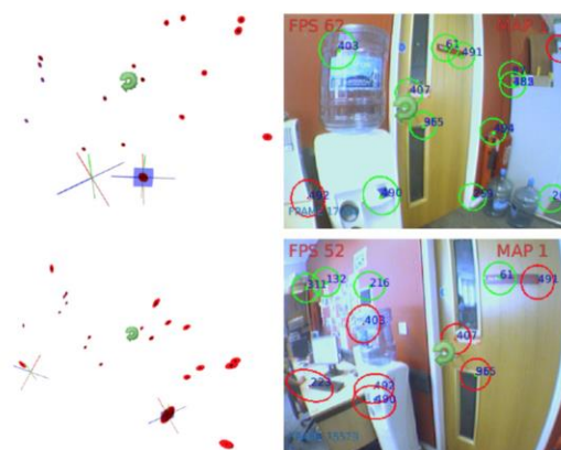
شکل ۴: نمونه ای از یک نقشه ناحیه ای که با استفاده از SLAM ساخته شده: (چپ) موقعیت قرار گیری دوربین و نقشه سه بعدی با کنواریانس مربوطه با قرمز نوشته شده است. (راست) نمای بینایی دوربین، که گیت های هوایی تشخیص داده شده (سبز) و تشخیص داده نشده (قرمز) را نمایش میدهد که به همراه ویژگی ها بصورت عبارات متنی بازتاب داده شده با استفاده از حقیقت افزوده (پیکان های چرخشی سبز) نشان داده شده اند. (برای درک رنگ های بکار رفته در این شکل، به نسخه اینترنتی این مقاله مراجعه کنید).
