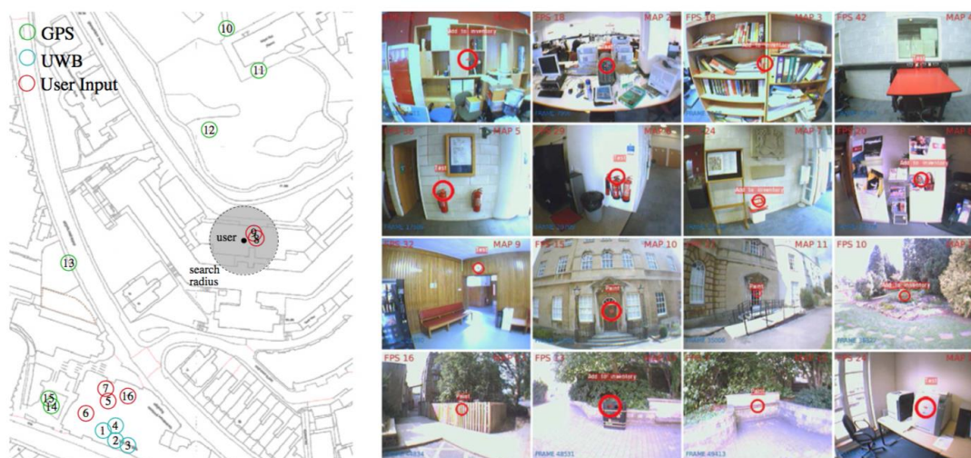
شکل ۱۳: نمونه ای از یک نقشه جهانی تولید شده با استفاده از سیستم ToMAR. شانزده نقشه ناحیه ای در بازه ۱۰۰ متری تهیه شدند که ترکیبی از نقاط داخلی و خارجی ساختمان را شامل میشدند و با بهره گیری از GPS, UWB و اطلاعات وارد شده توسط کاربر تولید شده بودند. بازه ۲۰ متری جستجو شده نشان میدهد که کاربر در حال حاضر در موقعیتی فاقد پوشش GPS و UWB به سر میبرد و همچنان اطلاعات را بصورت دستی در سیستم وارد میکند.
